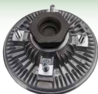
41118 Viscous Fan Ford 8340 - Clutch Type
